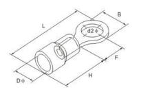
导线截面: 6~10mm<sup>2</sup>(美国线规8) 最大电流・Imax=62A
